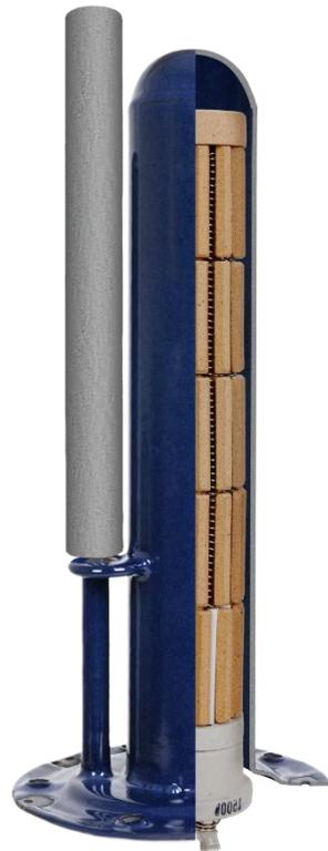
За счет увеличенной площади колбы повышается эффективность нагрева. Нагрев осуществляется нихромовой спиралью, размещенной между теплоемкими керамическими элементами, равномерно и быстро разогревающими колбу. Ключевые преимущества «сухого» нагревательного элемента CeramicHeat — надежность, длительный срок службы, стойкость к коррозии и образованию накипи, а также удобство технического обслуживания без слива воды.
