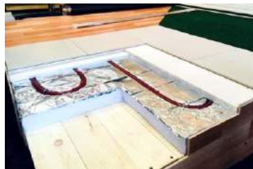
Фото сухого монтажа в пенополистирол/пенопласт 4-5см с вырезами под трубу + фольга не менее 70 мкр + лист ГВЛ/ГВЛВ/фанера
